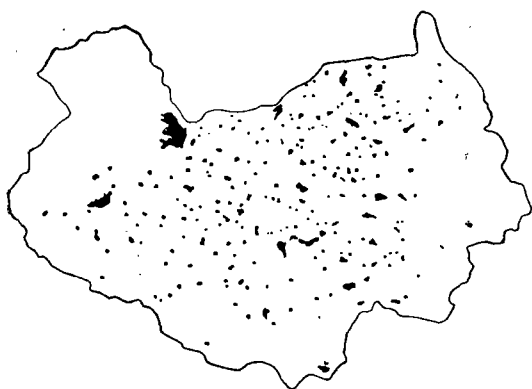
图 3 TM5 波段的水体判读图 Fig. 3 Water interpretation map from TM5 data
